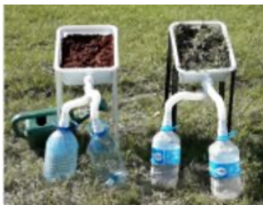
Figura 7: Modelo para simular o processo de escoamento superficial / infiltração da água, bem como a erosão / deposição do solo. Fonte: Banco de dados do CEPED / UNICENTRO (2019).
