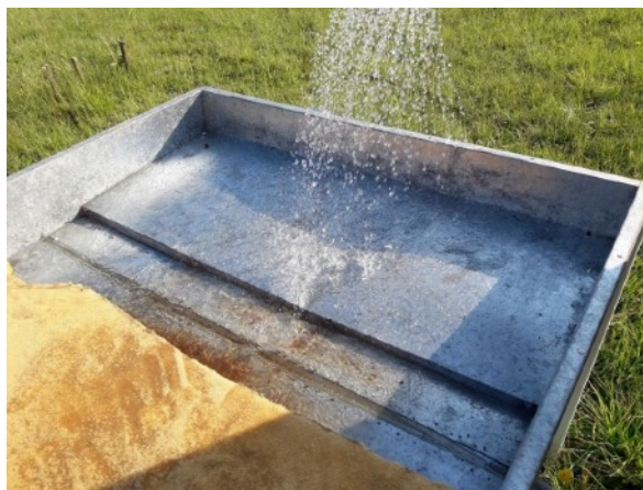
Figura 6: Simulador de escoamento superficial / infiltração / fluxo subterrâneo, nascente de água, bem como de inundação. Fonte: Banco de dados do CEPED / UNICENTRO (2019).
