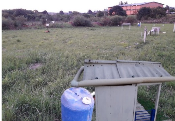
Figura 8: Maquete de edificação para coletar, recolher e armazenar água da chuva. Fonte: Banco de dados do CEPED / UNICENTRO (2019).
