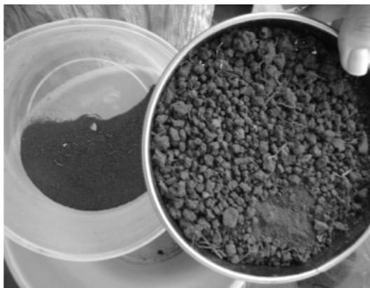
Figura 2: Foto dos materiais alternativos (peneira de fubá) usados para coar o solo, separando as partículas de diâmetros maiores como calhaus, cascalhos, torrões formados na secagem do solo, folhas e raízes.
