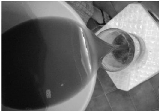
Figura 6: Solução do solo sendo transferida para um vasilhame, para posterior decantação das partículas finas nela dispersa. Observar a utilização de materiais alternativos como balde e garrafa PET.
