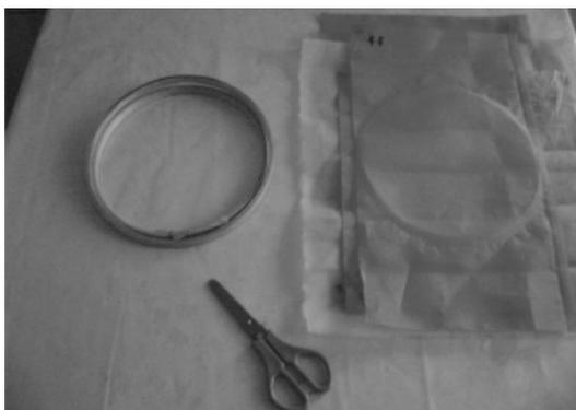
Figura 1: Foto dos materiais alternativos utilizados na confecção da peneira para a lavagem do solo. À esquerda bastidores usados para bordar e à direita tecido de poliéster usado em telas de serigrafia.
