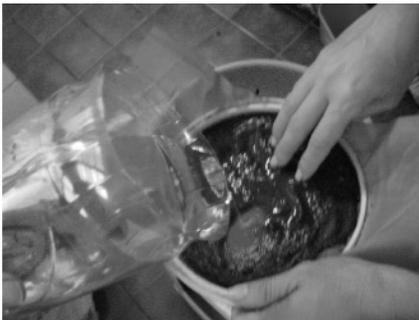
Figuras 3, 4 e 5: Fotos da lavagem do solo para separar as partículas grossas do solo. Observar a utilização de materiais alternativos como baldes, garrafas PET, tecido de poliéster e bastidores para bordar.
